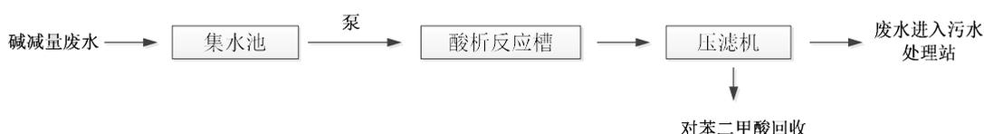
图 8.2-1 碱减量废水处理工艺流程图
